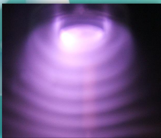
Свечение низкотемпературной плазмы в вакууме генератора
